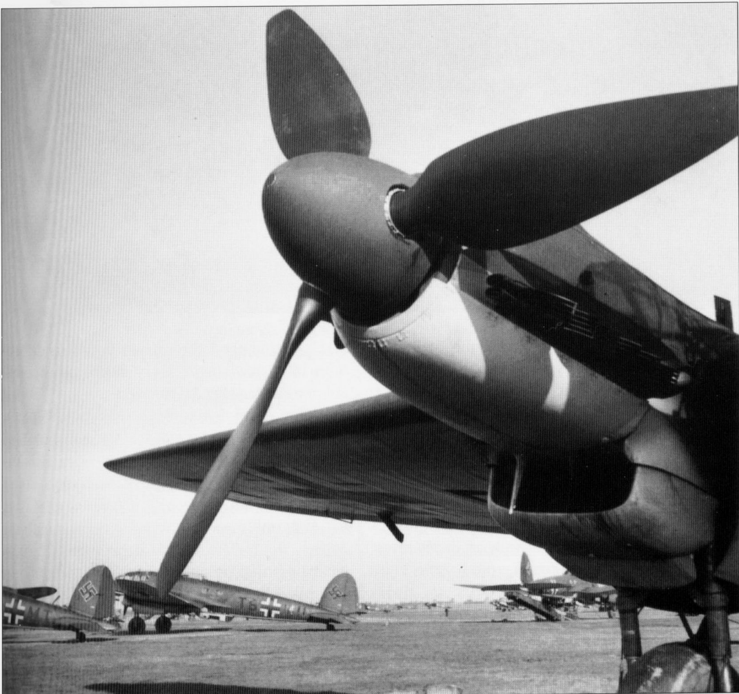
Zbliżenie silnika Jumo 211. Ta jednostka napędowa stała się podstawą rozwoju bombowca He 111H, gdyż silniki DB 601 zostały przeznaczone wyłącznie dla myśliwców Messerschmitta.
